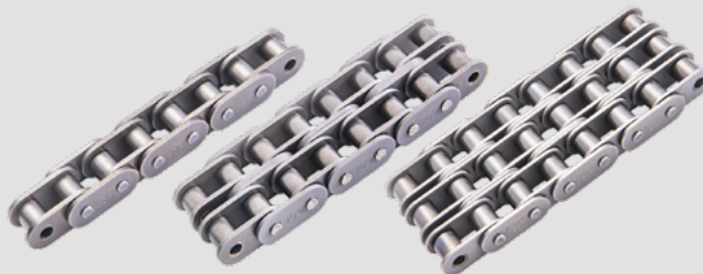
Rollenketten mit geraden Laschen ISO 606 (DIN 8187, DIN 8188) und Werksnormen - simplex, duplex, triplex
